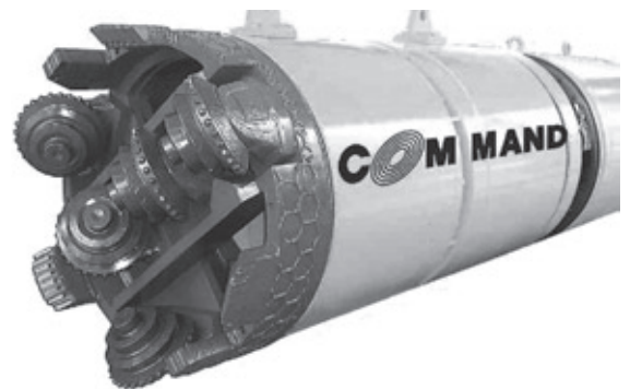
写真-4 コマンド-S工法
